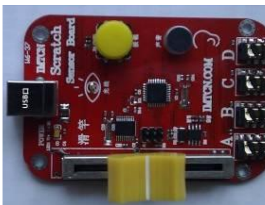
图 1 Scratch 传感器板
